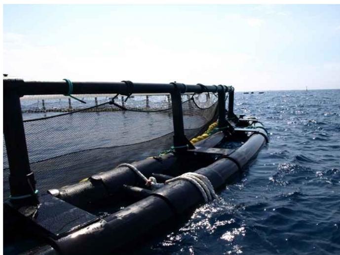
*Figure 5.5 – Exemple de cage circulaire en PE*
